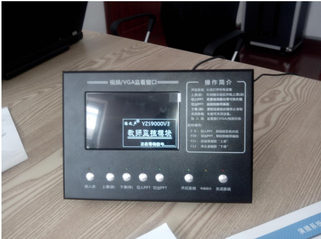
中控台除了能管理课室所有媒体设备外，还能通过网络中控远程开启录播、跟踪等所有系统设备并进行远程管理。
